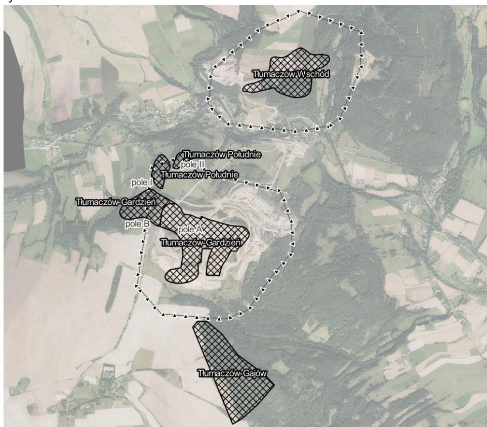
Rysunek 9. Udokumentowane złoża kamieni drogowych i budowlanych w Tłumaczowie i Gajowie. Udokumentowane złoża oznaczono szrafem. Złoże eksploatowane oznaczono dodatkową obwiednią [źródło: Państwowy Instytut Geologiczny]
